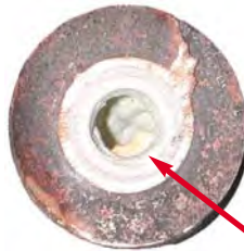
Copper Fin Tube (Scale) (Erosion)
